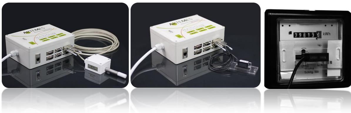
Abbildung 3: Clog-Box mit Temperatur und Feuchtigkeitsfühler (links), mit Strommessgerät (mitte, rechts) [3]
