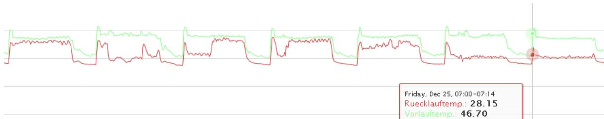
Abbildung 2: Grafische Betrachtung der Messwerte (Vorlauftemperatur, Rücklauftemperatur der Heizung) von einer Woche über das Webinterface [3]
