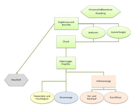
Abbildung 4: Schematische Darstellung des Informations- und Datenflusses. Die Messwerte werden vom Haushalt über die Clog-Boxen und den Datenserver zur Auswertung an das Wissenschaftszentrum übermittelt. Anschließend können Ergebnisse und Berichte an die Haushalte verteilt werden. [Quelle: eigene Darstellung]
