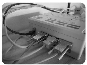
Abbildung 1: ARTEMES Clog-Box mit Wärmemengenzähler, Stromzähler und Außentemperaturfühler [Quelle: eigene Darstellung]
